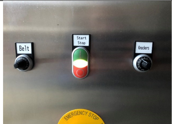
Bedienung der Anlage: Über den Drehschalter "Belt" kann die Geschwindigkeit des Förderbandes angepasst werden. Der Drehschalter "Knockers" regelt die Klopperrollen, welche das Förderband auf und ab bewegen.
