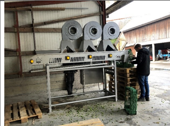
Entwässerungseinheit mit drei Gebläsen und dem Förderband.
