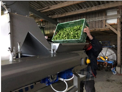
Kippen der Kisten auf die Entwässerungsanlage.
